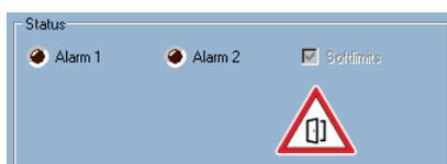
Falls Ihre Maschine mit einer Umhausung ausgerüstet ist, verhindert die Sicherheitstür-Funktion, dass die Maschine bewegt werden kann, solange die Türe geöffnet ist, und der Anwender in den gefährdeten Bereich der Maschine greifen kann. Das Starten von Programmen und das Einschalten des Spindelmotors oder anderen Ausgängen ist nur bei geschlossener Türe möglich. Solange die Türe geöffnet ist, wird das dreieckige Warnsymbol mit der offenen Türe im Status-Feld angezeigt.
