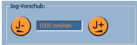
Diese Knöpfe verringern oder erhöhen die eingestellte Jog-Geschwindigkeit, welche in der Anzeige zwischen diesen Knöpfen dargestellt wird.
