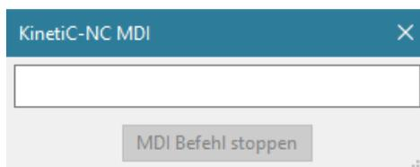
Die Schaltfläche „MDI“ oben in der Mitte öffnet ein Fenster mit einem Texteingabefeld. Hier können Sie G-Code Befehle direkt eingeben. Dies kann nützlich sein, um bestimmte Positionen anzufahren, oder Befehle einzugeben, die einen bestimmten Modus oder eine bestimmte Funktion aktivieren.
