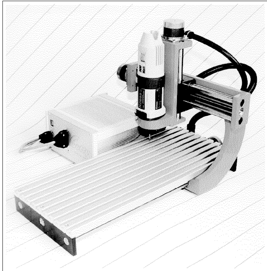
Bild 1-1 Beispiel einer 3-Achs-Fräsanlage
