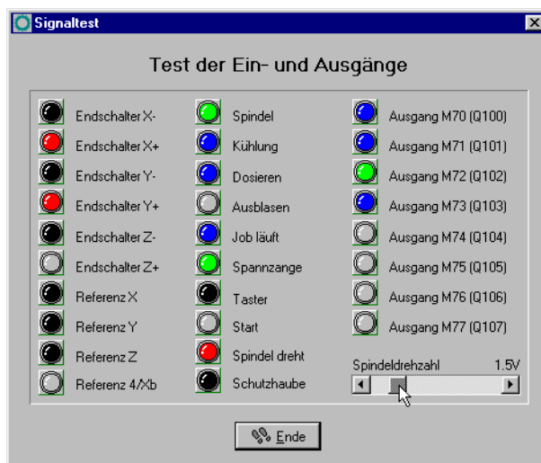
Sonderfunktion SIGNALTEST mit LED-Anzeigen der wichtigsten Eingänge
